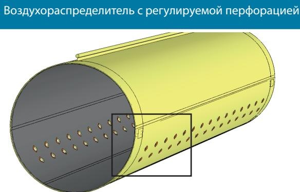
**Регулирование воздушного потока**
