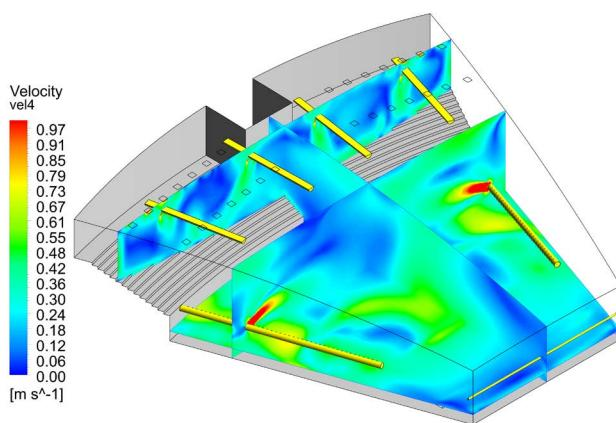
Обычный текстильный воздуховод используется при тех же скоростях воздуха, что и традиционный трубопровод. Максимально допустимая скорость воздушного потока ограничивается с одной стороны аэродинамическими требованиями к помещению, в котором будет установлена система, а с другой стороны возможностью турбулизации потока, которая может вызвать вибрацию ткани. При расчетах необходимо учитывать конкретные значения потока, уровень статического давления и вес ткани.
