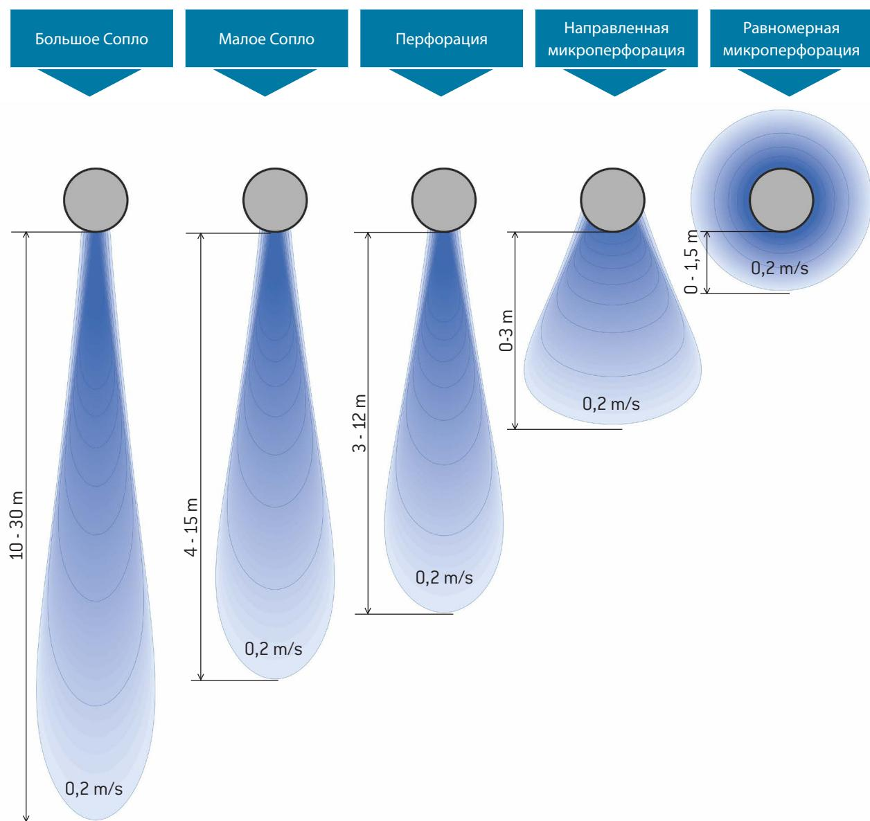
Досягаемость воздушного потока меняется в зависимости от статического давления в воздуховоде и разности температур.
