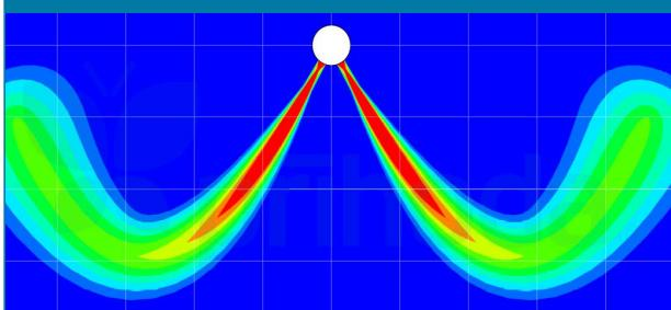
Воздушные потоки, смоделированные PRIHODA с использованием ПО Fluent
